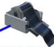
Элемент антенны («луч»), находящийся в «свернутом» состоянии на посадочном модуле и разворачиваемый с помощью лунохода.
